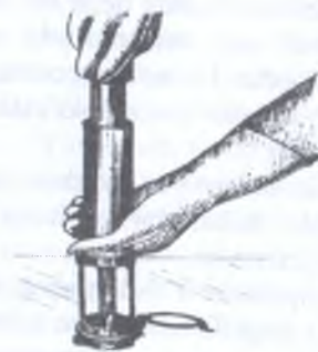
Şəkil 3.17. Zəhərlənməni əşyanın səthində tə'yin etmək
