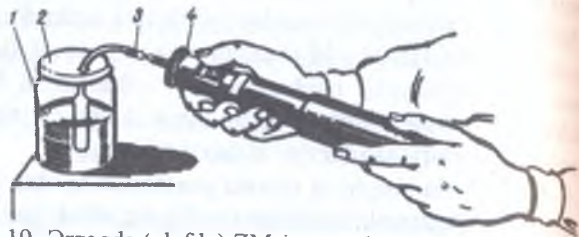
Şəkil 3.19. Ərzaqda (alafda) ZM-in quru hava ekstraksiyası və indikator borucuqları vasitəsilə aşkar (indikasiya) edilməsi. 1 – şüşə qab; 2 – qapaq; 3 – indikator borucuğu; 4 – nasosun başlığı.
