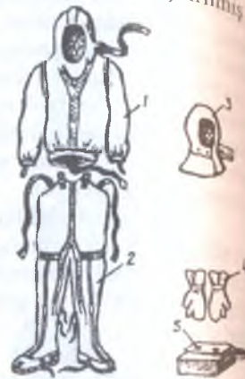
Şəkil 4.23. Yüngül mühafizə kostyumu – L-1; 1 – gödəkçə başlıqla; 2 – şalvar corabla; 3 – başlıqaltı; 4 – əlcək; 5 – torba.
